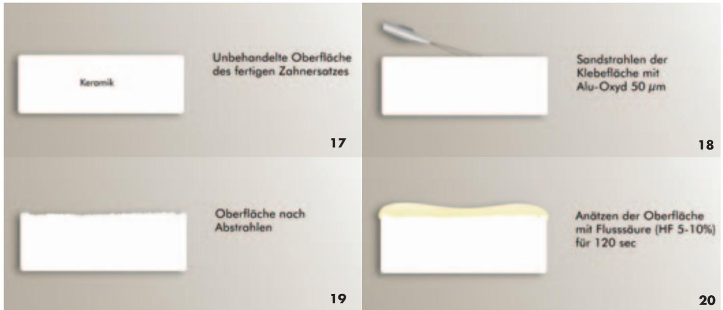
Abb. 17 bis 20 Auswirkung verschiedener Oberflächenkonditionierungen auf Keramik
